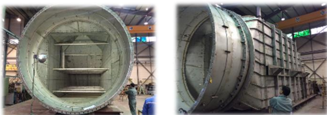
脱硫設備用大型ダクト (韓国)
